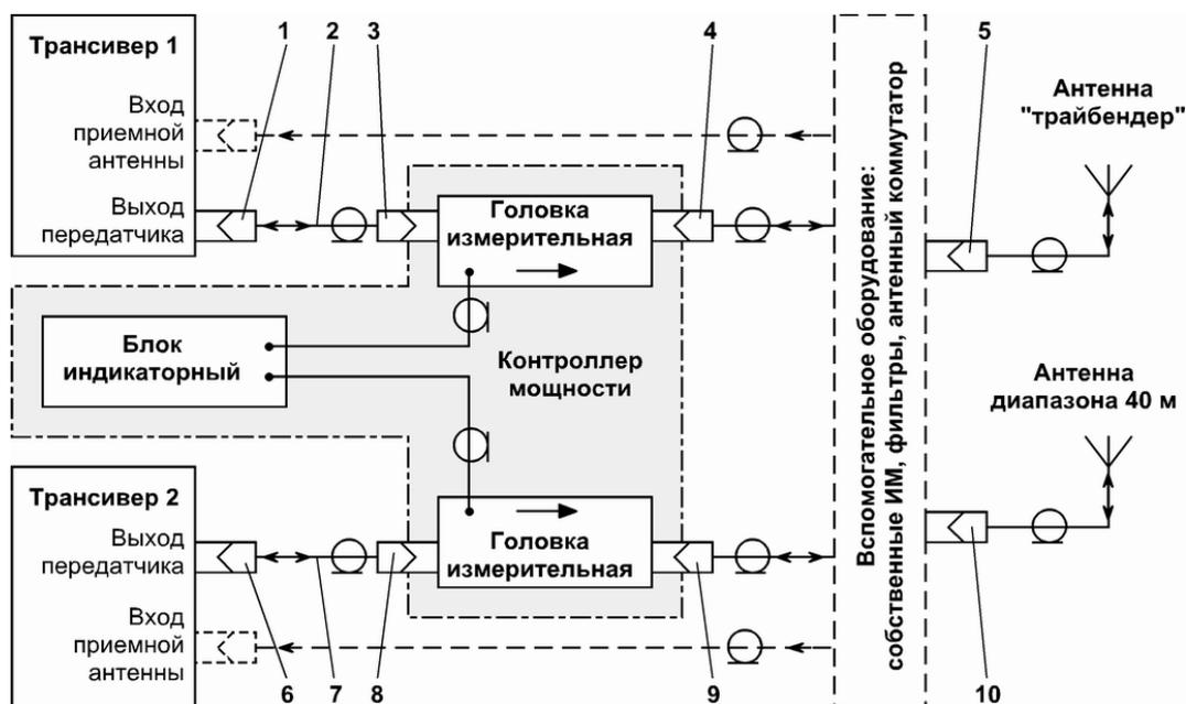
Обозначения: 1, 3-5, 6, 8-10 – соединение SO-238/PL-259; 2, 7 – отрезок кабеля по п. 1.2 [1]; штриховой линией показаны необязательные узлы и соединения.
